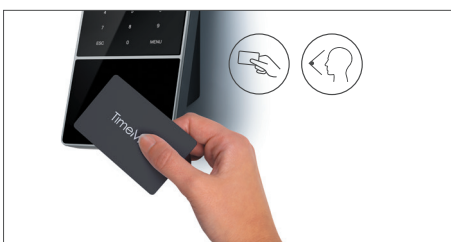
Se puede fichar con tarjeta de proximidad RFID, con reconocimiento facial o con código PIN
